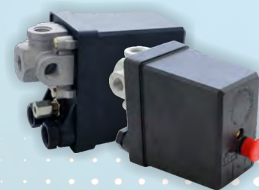
WYŁĄCZNIK CIŚNIENIOWY BEZ ZABEZPIECZENIA TERMICZNEGO 400V 10 bar 4X1/4"W KOD: PRE.5004
