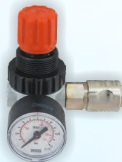
REDUKTOR MK 200 CIŚNIENIE ROBOCZE 0-10 bar MAX.CIŚNIENIE WEJŚCIOWE 12 bar PRZYŁĄCZE G1/4" W KOD: RED 201
