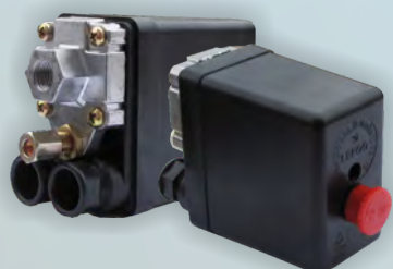
WYŁĄCZNIK CIŚNIENIOWY BEZ ZABEZPIECZENIA TERMICZNEGO HS 230V 8 bar 1X1/4"W KOD: PRE.5001 HS
