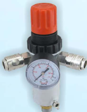
REDUKTOR MK 13/BK14/19 CIŚNIENIE ROBOCZE 0-10 bar MAX.CIŚNIENIE WEJŚCIOWE 12 bar PRZYŁĄCZE G1/2" Z KOD: RED 300.1
